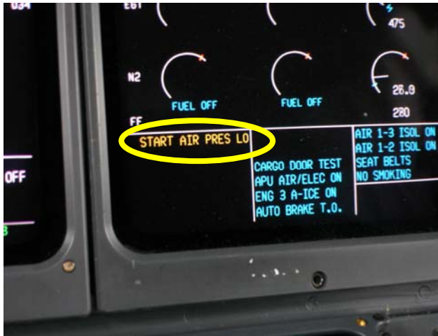
Bild 2: Warnung „START AIR PRESS LO“ (MD 11) am „Engine and Alert Display, EAD“ (aufgenommen in Nairobi)
