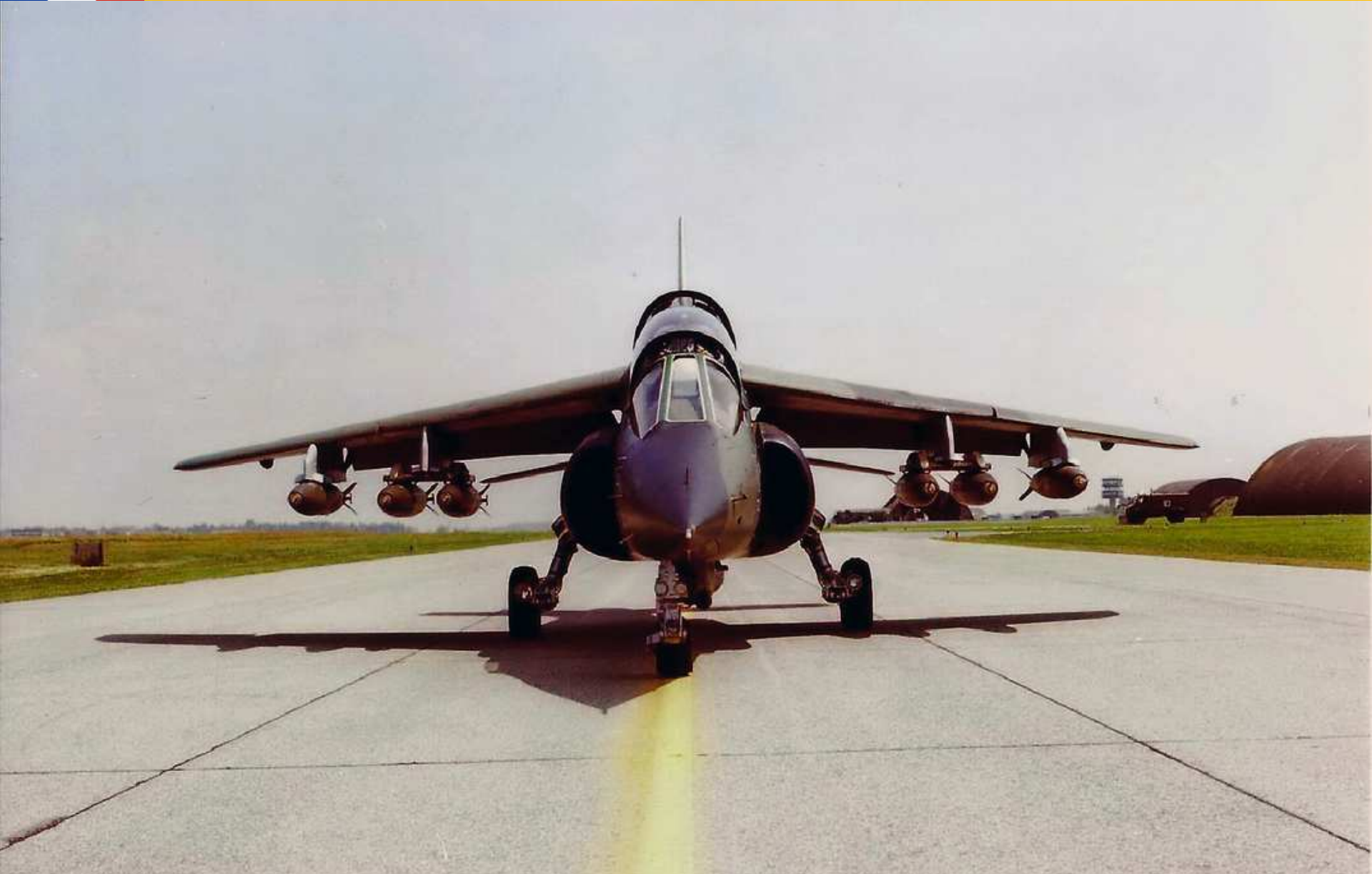
ALPHA JET mit Außenlasten, 6 Bomben Mk82 (à 250 Kg)
